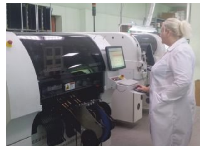
МОНТАЖ СВЕТОДИОДОВ НА ПЕЧАТНЫЕ ПЛАТЫ
